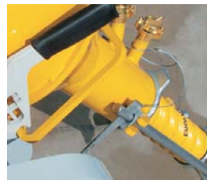
Keilsystem zum Einbau von Stator und Rotor
